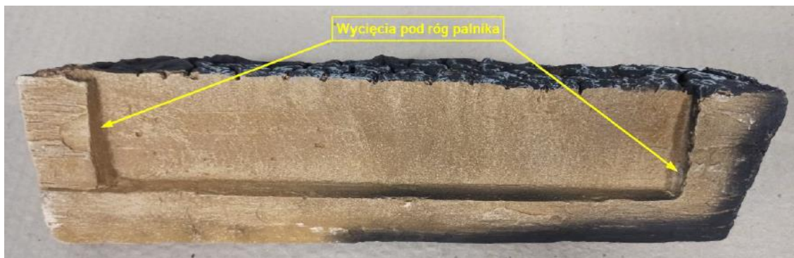
Rysunek 26. Wcięcia w elementach 2 i 3, które ułatwiają ułożenie na rogach palnika.
